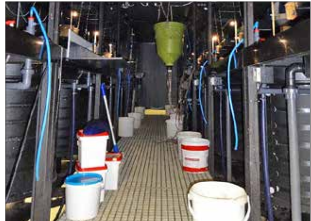
Abb. 2 - Kreislaufmodul für Versuchsdurchführung in der Aquakulturanlage Born mit jeweils sechs 0,5 m 3 -Becken rechts und links. Siebtrommelfilter, Biofil-ter und UV-Anlage sind nicht abgebildet.
