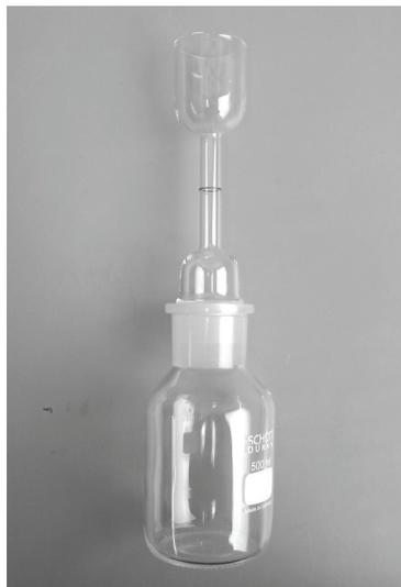
Abb. 1: Flaschenpyknometer 500 ml.
